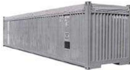
Los contenedores de techo abierto fueron desarrollados para determinadas cargas que no son aptas para ser introducidas por la puerta. Sin techo, la carga es estibada a través del techo. Una lona encerada asegurada por ganchos cubre y protege la carga. El contenedor de techo abierto es construido en dos dimensiones básicas: 20' y 40'.
